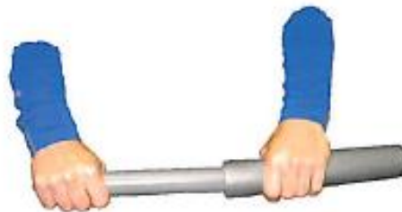
Afbeelding 11: Pvc-buis en isolatieschuim in elkaar schuiven.
